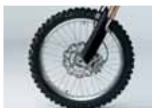
Lekki zacisk hamulca przedniego i opony z serii Dunlop MX52
