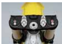
Widelec PSF2 (z pneumatycznymi sprężynami KYB)
