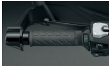
Podgrzewane manetki 57100-25820-000 Doskonale rozplanowane strefy grzania zapewniają najwyższy komfort podróżowania nawet w niesprzyjających warunkach. Panel sterujący do wyboru jednego z 3 trybów pracy. Najlepszy efekt w połączeniu z osłonami dłoni (nr kat. 57300-25810-000).
