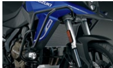
Rurowa osłona silnika 94200-25810-000 Niezawodna ochrona motocykla przy utracie stabilności. Nadaje off-roadowego charakteru Twojemu V-STROMowi. Czarna, lakierowana proszkowo. Wymagana do montażu reflektorów przeciwmgielnych LED (nr kat. 99172-25L00-00). Do montażu wymagana dolna osłona rurowa (nr kat. 41100-25810-000).
