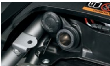
Gniazdo zasilania 12V 38800-31810-000 Klasyczne gniazdo zasilania akcesoriów. Montowane w schowku, pod siedziskiem.
