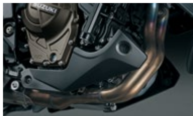
Osłony boczne silnika 94400-25820-000 Elegancki wygląd w mieście. Czarne. Komplet 2 szt. Wyklucza montaż osłony rurowej (nr kat. 41100-25810-000).
