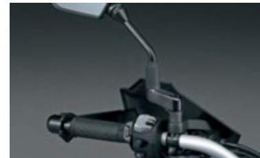
Przedłużenia ramion lusterek 56700-25820-000 Podnoszą wysokość lusterek o 50 mm oraz umożliwiają wysunięcie o 40 mm z każdej strony. W przypadku montażu z osłonami dłoni (nr kat. 57300-25810-000) należy zastosować tuleje dystansowe (nr kat. 56000-25810-000).
