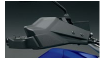
Osłony dłoni 57300-25810-000 Chronią dłonie przed wiatrem oraz uderzeniami kamieni i owadów. W przypadku montażu z przedłużeniami lusterek (nr kat. 56700-25820-000) należy zastosować tuleje dystansowe (nr kat. 56000-25810-000).
