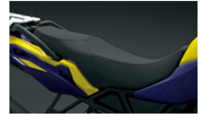
Podwyższone siedzisko 45100-25LD0-CKA Zastępuje oryginalne siedzenie, podwyższa wysokość o 30 mm.
