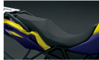
Obniżone siedzisko 45100-25LC0-CKA Zastępuje oryginalne siedzenie, obniża wysokość o 20 mm.
