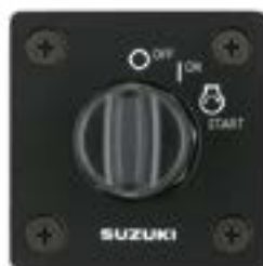
PANEL WYŁĄCZNIKA ZAPŁONU (PODWÓJNY WYŁĄCZNIK ZAPŁONU Z WYŁĄCZNIKIEM AWARYJNYM)
