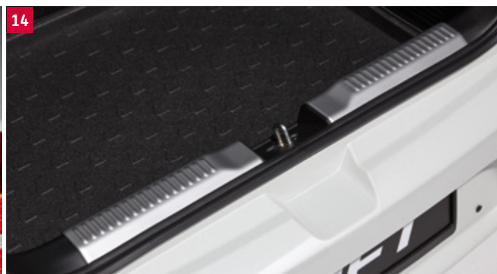
14 | NAKŁADKA OCHRONNA WEWNĘTRZNEJ KRAWĘDZI BAGAŻNIKA Wykończenie w stylu szczotkowanego aluminium, wykonana z tworzywa, chroni tylną krawędź bagażnika przed zarysowaniem przy załadunku i rozładunku. Nr kat. 990E0-53R52-000
