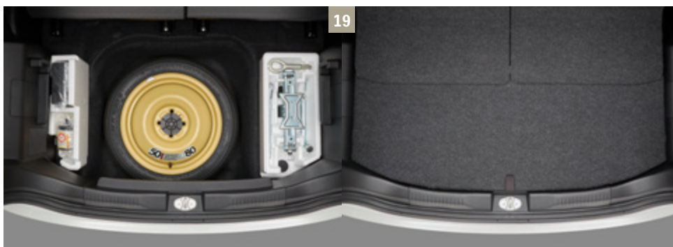
19 | ZESTAW KOŁA DOJAZDOWEGO 2WD 1 WVTA Zestaw zawiera koło dojazdowe, podnośnik i klucze oraz elementy montażowe. Nr kat. 9929P-62R00-000
