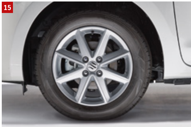
15 | FELGA Z LEKKIEGO STOPU „SAMBA” Srebrna, lakierowana, rozmiar 5Jx15”, do opon 175/65R15, z centralną zaślepką z logo Suzuki. Atesty ECE R124 i JWL.
