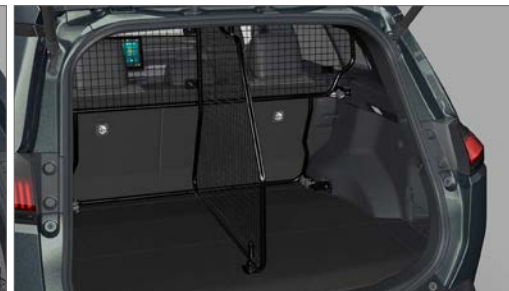
4 | KRATA DZIELĄCA PRZESTRZEŃ ŁADUNKOWĄ (WZDŁUŻNA) Czarna Stalowa, lakierowana proszkowo. Dzieli przestrzeń bagażową na dwie części. Tylko w połączeniu z kratą oddzielającą (nr kat. 99002-55Z00-007). Nr kat. 99002-55Z00-008
