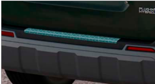
8 | FOLIA OCHRONNA NA TYŁNY ZDERZAK Transparentna Chroni powierzchnię zderzaka przed zarysowaniami. Nr kat. 99002-55Z00-010
