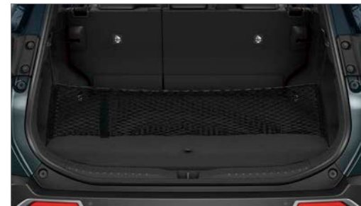
1 | PIONOWA SIATKA PRZESTRZENI BAGAŻOWEJ Czarna Zapobiega wypadaniu przewożonych przedmiotów przy otwieraniu drzwi bagażnika. Nr kat. 99002-55Z00-006
