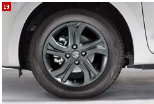
19 | FELGA Z LEKKIEGO STOPU „COSMIC” Matowoczarne wykończenie, lakierowana, rozmiar 5Jx15”, do opon 175/65R15, z centralną zaślepką z logo Suzuki. Atesty ECE R124 i JWL.
