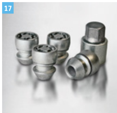
17 | ANTYKRADZIEŻOWE NAKRĘTKI DO KÓŁ „SICUSTAR” Z atestem Thatcham. Nr kat. 990E0-59J47-000
