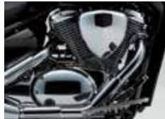
Chłodzony cieczą silnik 45° V-Twin
