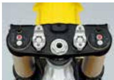
Widelec przedni PSF2 (Ze sprężynami gazowymi KYB)
