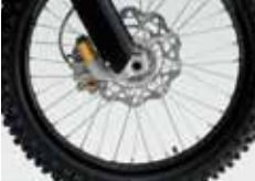
Kola szprychowe EXCEL i falowane tarcze hamulcowe typu „Wave”
