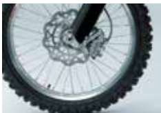
Lekki przedni zacisk hamulcowy i opona Dunlop MX52
