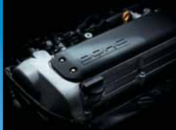
Aluminiowy silnik M13A DOHC 16-zaworowy 1328 cm 3
