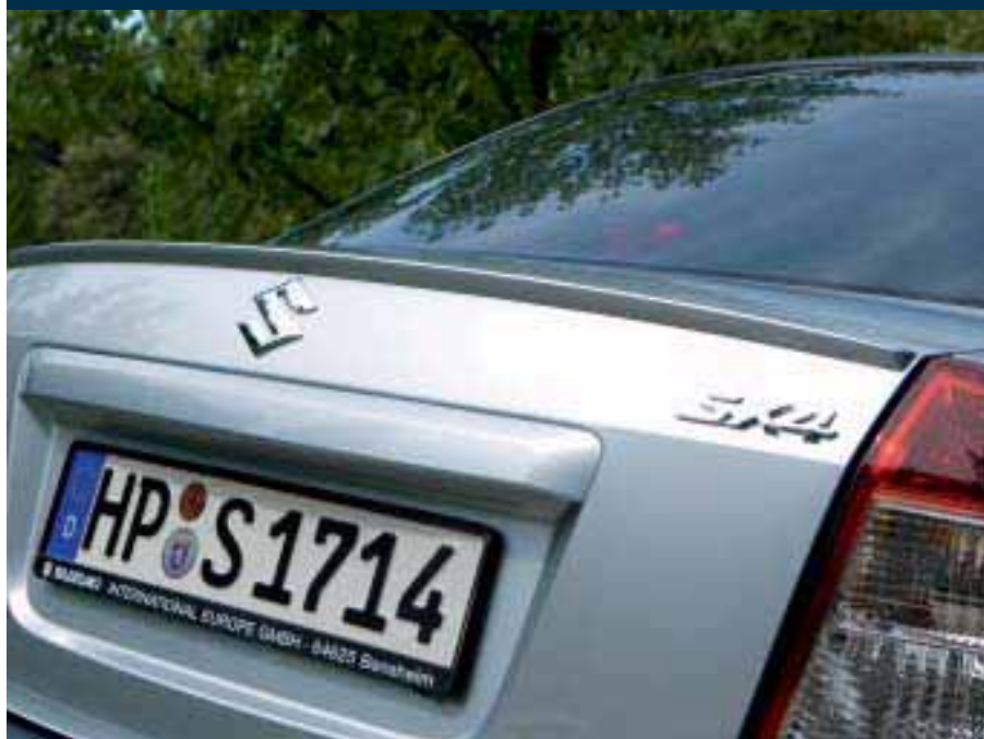
Spojler pokrywy bagażnika Zagruntowany, zalecane lakierowanie w kolorze nadwozia. Nr ewid. 990E0-80J07-000
