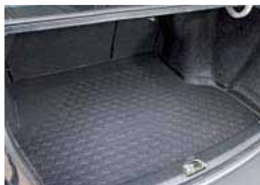
Wykładzina bagażnika dopasowana, wodoszczelna Nr ewid. 990E0-75K02-000
