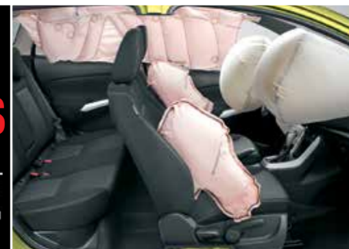
Poduszki powietrzne: czołowe, boczne oraz kurtynowe (obejmujące przedni i tylny rząd siedzeń)
