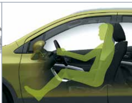
System składania pedału hamulca redukujący obrażenia stóp i nóg w chwili kolizji
