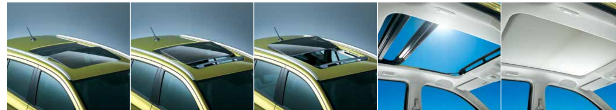
Przeszkłony dach panoramiczny, elektrycznie otwierany (zawiera 2 przesuwane panele szklane)
