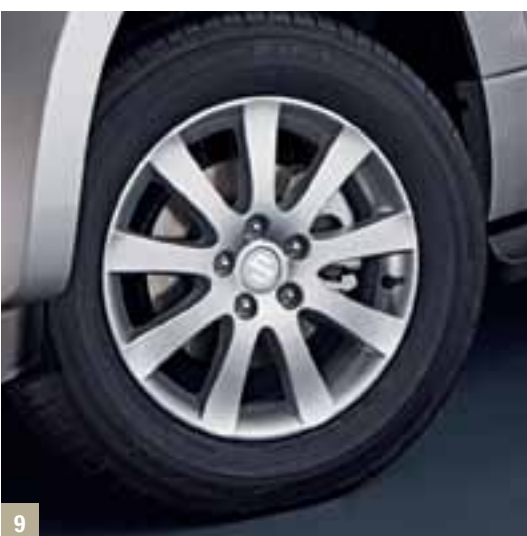
9 | Felga z lekkiego stopu, 6,5 J x 17" Wzór 9-ramienny, do opon 225/65 R17 102 i do montażu z fabrycznymi nakrętkami, z osłoną piasty z logo Suzuki, z nakrętkami, WVTA Nr kat. 990E0-65J24-000
